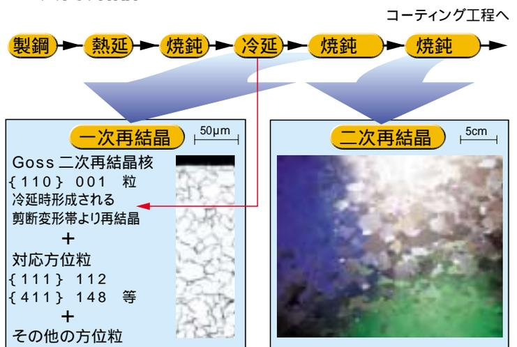
一次再結晶した結晶粒のうち優れた磁氣的性質を持つ「Goss 方位粒」が、磁氣的性質に劣る結晶粒を“蚕食”しながら成長することにより、結晶方位が揃う。
