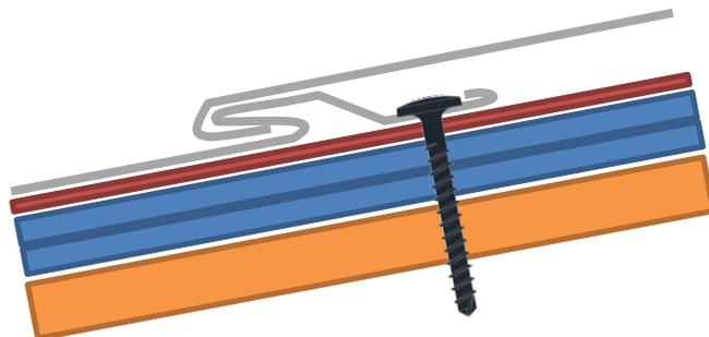
— 新設金属屋根 — ルーフィング — 既設スレート瓦 — 野地板
